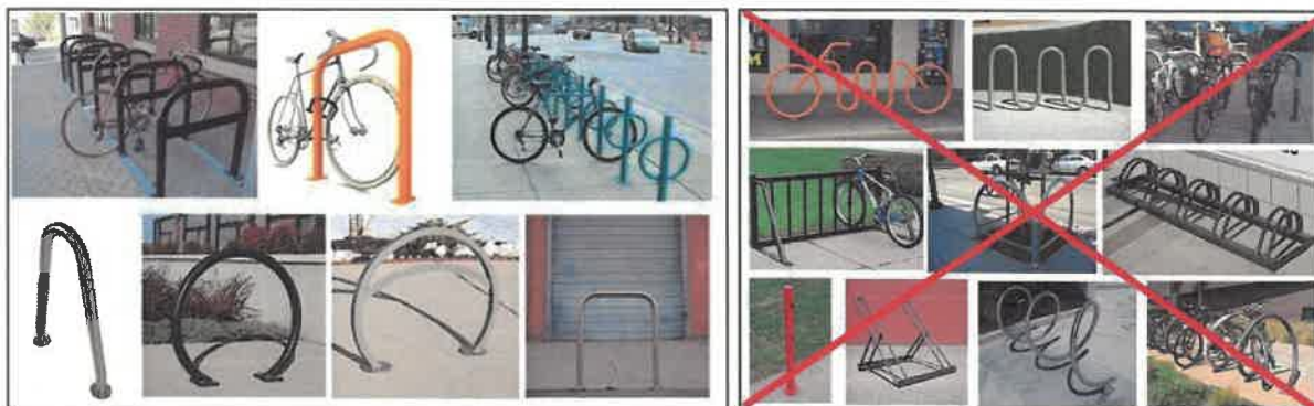
Figura 221.: Suporturi pentru biciclete recomandate și nerecomandate 141
