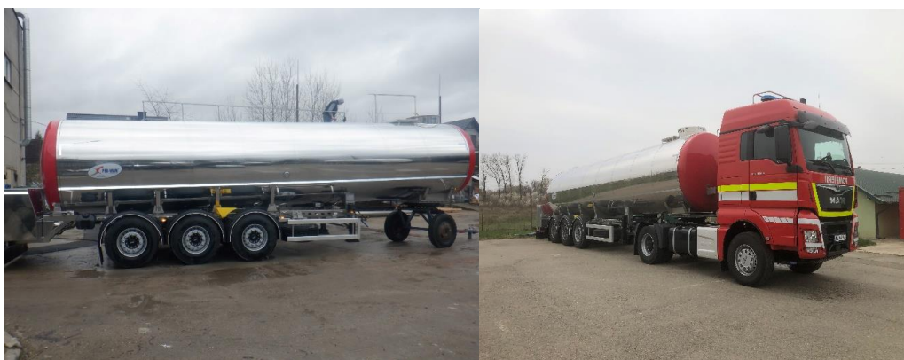
Semiremorcă cisternă de mare capacitate pentru transport apă
