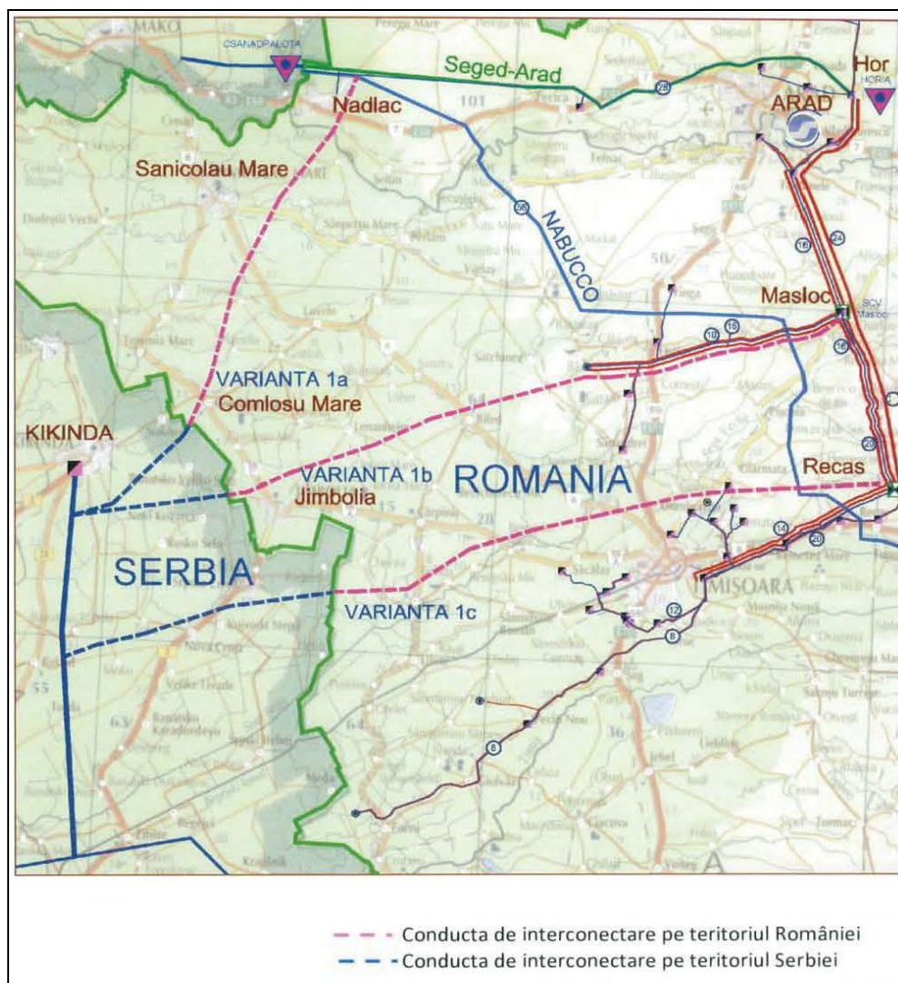
Figura nr. 26 - Variante de interconectare a Sistemului Național de Transport gaze naturale cu Serbia
